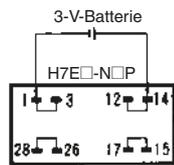
Beachten Sie beim Aufbau eines Schaltkreises darauf, dass die Drähte für den Anschluss an die Versorgungsspannung kürzer als 50 mm sind. Weitere Informationen zur ordnungsgemäßen Polarität finden Sie im Anschlussschema oben.
