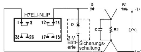
Verwenden Sie eine Diode (D) mit kleinstmöglicher Durchlassspannung (max. 0,1 V bei  $I_F$  von 20 μA).
