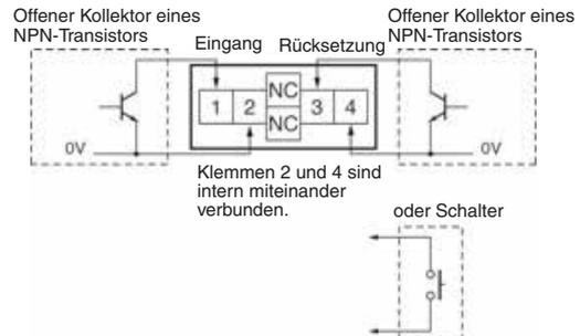
**Hinweis: 1.** Die Restspannung im Ausgangsteil von Näherungssensoren oder optischen Sensoren beträgt weniger als 0,5 V, da von Klemme 1 oder 3 ein geringer Strom von nur ca.  $10 \mu A$  fließt, wodurch ein einfacher Anschluss ermöglicht wird.
