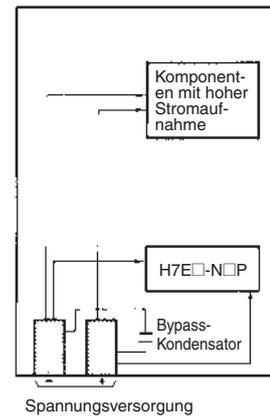
Löten Sie den Zähler direkt an eine Leiterplatte und befestigen Sie ihn nicht mit Hilfe von Sockeln, wenn er häufigen Vibrationen oder Stößen ausgesetzt ist, oder der Zähler nach unten oder seitwärts ausgerichtet montiert werden soll.
