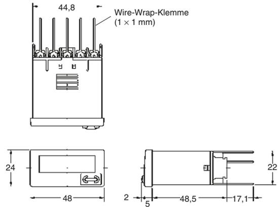
Achten Sie bei Verwendung der Wire-Wrap-Klemme darauf, die korrekten Drähte und Peripheriegeräte einzusetzen. (Die korrekten Drähte, Bits und Hülsen sind rechts in der Tabelle aufgeführt.)
