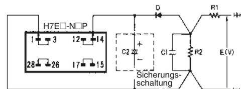
Wenn ein Kondensator verwendet wird, kann die durch ihn erzielbare Sicherungszeit anhand folgender Formel berechnet werden:
