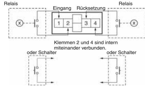
**Hinweis:** Es müssen Relais oder Schalter mit einer hohen Kontaktzuverlässigkeit verwendet werden, da der von Klemme 1 oder 3 fließende Strom klein ist. Es wird empfohlen, das OMRON G3TA-IA/ID als Halbleiterrelais zu verwenden.
