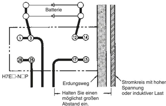
Legen Sie an die Zähl-/Zeitrelais-Eingangsklemmen und Rücksetzeingangsklemmen keine Spannung an, die die folgenden Spannungswerte überschreitet. Anderenfalls kann die interne Schaltung beschädigt werden.
