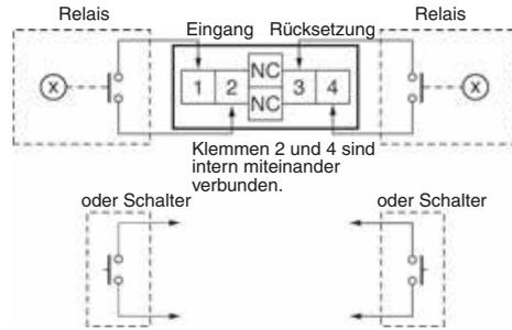
**Hinweis:** Es müssen Relais oder Schalter mit einer hohen Kontaktzuverlässigkeit verwendet werden, da der von Klemme 1 oder 3 fließende Strom mit nur ca.  $10 \mu A$  gering ist. Es wird empfohlen, das OMRON G3TA-IA/ID als Halbleiterrelais zu verwenden.
