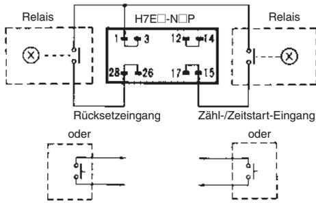
Bei Verwendung des H7EC-NP kann Prellen der Relaiskontakte gezählt werden. Verwenden Sie deshalb den H7EC-NLP, dessen Eingang für langsame Zählvorgänge ausgelegt ist.
