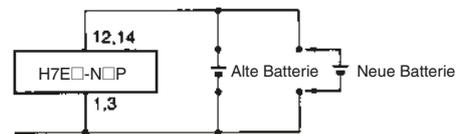
Die Polarität der Verdrahtung muss sorgfältig geprüft werden, um dauerhafte Schäden der Zähler zu verhindern. Gehen Sie äußerst sorgfältig vor, wenn Sie den Zähler in den Sockel einsetzen, um eine umgekehrte Polarität zu vermeiden.
