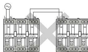
Bei der Koppelung von Basismodulen muss darauf geachtet werden, dass nur die Erdungsklemme eines einzigen Moduls angeklemmt wird.
