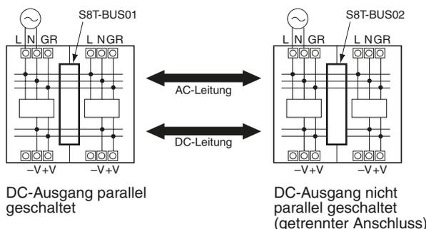
**Hinweis:** Der serielle Betrieb mit Modulen verschiedener Spezifikationen ist möglich, allerdings darf der Laststrom nicht stärker sein als der Nenn-Ausgangsstrom eines jedes Moduls.
