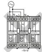
Verdrahten Sie die Module nicht untereinander oder mit anderen Geräten über Kreuz. Bei Überschreitung des Nennstroms kann es zu einer Beschädigung der Bus-Steckverbinder kommen.
