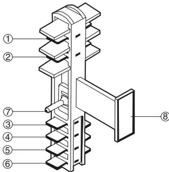
S8T-BUS02 Bus-Steckverbinder (AC-Bus)
