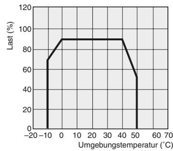
**Hinweis:** Setzen Sie bei Problemen aufgrund der Reduktion ein Zwangsluftkühlung ein. Die Umgebungstemperatur wird für einen Punkt angegeben, der sich 50 mm unterhalb des Netzteils befindet.
