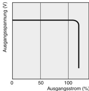
**Hinweis:** Sorgen Sie dafür, dass ein Kurzschluss- bzw. Überlastzustand nicht länger als 20 s bestehen bleibt, da andernfalls Bauteile beschädigt werden können.
