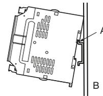
So bauen Sie ein Modul von einer DIN-Schiene ab: Verriegelung C mit einem Schlitzschraubendreher herabdrücken und Modul von der Schiene abheben.
