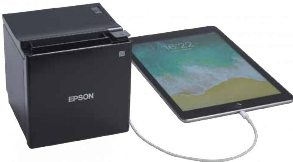
Die mPOS-Lösung TM-m30II-NT bietet Netzwerk-Tethering für eine kabelgebundene Internetverbindung zwischen Drucker und Tablet.
