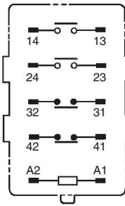
**Hinweis:** Anschlüsse 43 und 44 von G7J-4A-P(B)(T)(Z) und Kontakte 41 und 42 von G7J-3A1B-P(B)(T)(Z) sind gegabelte Kontakte.
