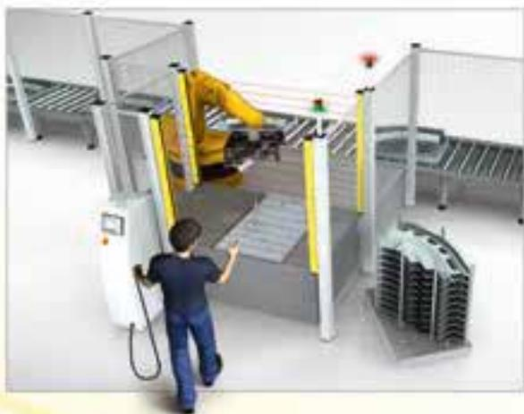
Die sichere Wartung und Konfiguration werden durch die direkte Verbindung mit A4EG-Zustimmtastern unterstützt.
