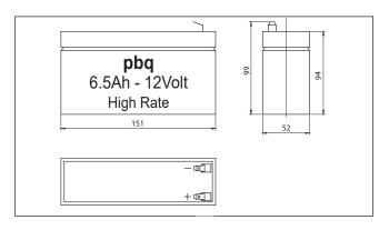
Voltage : 12 Volt Capacity : 6.5Ah/20hr
