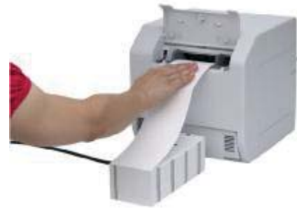
Verarbeitung von Fan-fold Papierformaten
