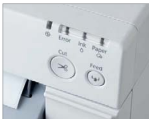
Bedienelemente an der Vorderseite für leichten Zugang
