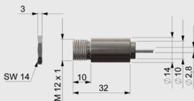
Abmessungen optris® CSmicro 3M CF1
